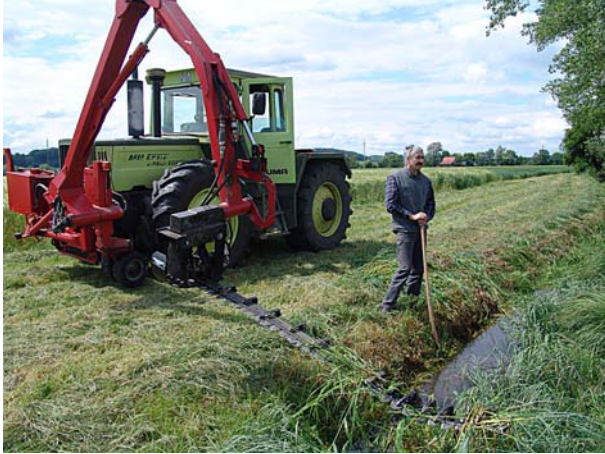
Schonendste Mahdmethode der Böschung und der Sohle – ein am Ende gebogener Doppelmesserbalken am seitlichen Ausleger
