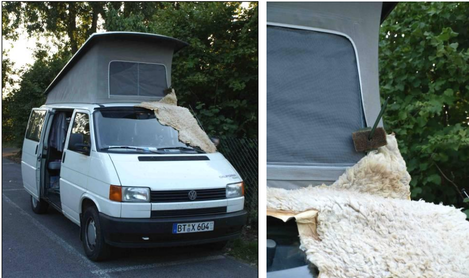
Abbildung 3: batcorder im stationären Einsatz im Faltdach eines Transporters (Fotos: C. Strätz)
