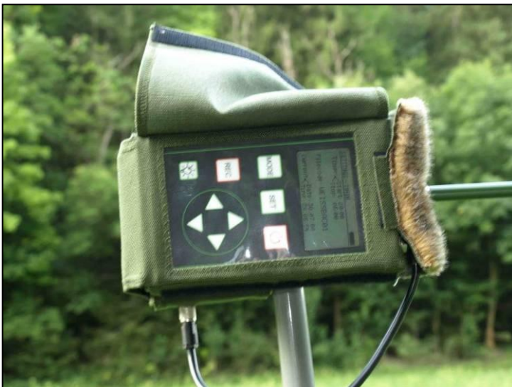
Abbildung 2: batcorder1.0 am Gestänge; ca. 2,5 m Abstand zum Boden und seitlichen Strukturen; (Foto: C. Strätz)
